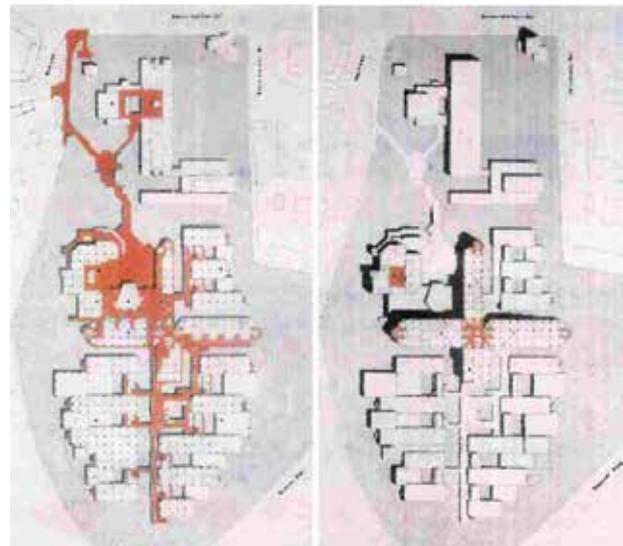
Links: Erdgeschossenebene 2 mit Fußgängerbrücken, rechts: Ebene 8 des zwölfgeschossigen Hochhauses des Zentralbereichs
